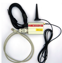
Bild 3: Funkmodul zur Anbindung an das öffentliche Mobilfunknetz
