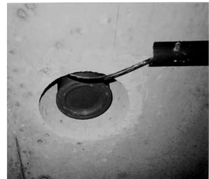
Bild 2: Ultraschallsensor in einer Deckenaussparung
