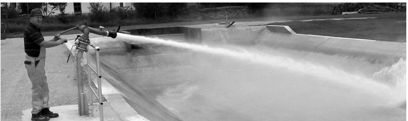
Der Aufschlagimpuls, insbesondere des Vollstrahls aus kurzer Entfernung, hat eine solche Wucht, dass erheblicher Schaden, selbst an Beton- und Stahlbauteilen, angerichtet werden
