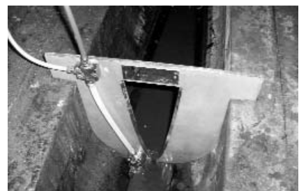
Bild 6: Ausführungsbeispiel für eine Parabelmessblende UFT-FluidVenturi mit Druckmessung im Luftpfeilverfahren
