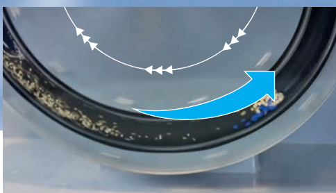
Regenwetterabfluss: Schweb- und Schwimmstoffe gelangen an die Spitze der Welle (rechts)
