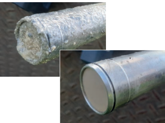
Die zuvor mit Fett belegte Drucksonde zur Wasserstandsmessung glänzt nach der Reinigung wieder silbern
