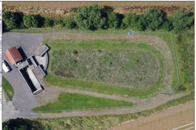
Blick auf die Anlage knapp 20 Jahre nach Fertigstellung: links das offene Regenüberlaufbecken mit Pumpwerk, rechts der große Retentionsbodenfilter
