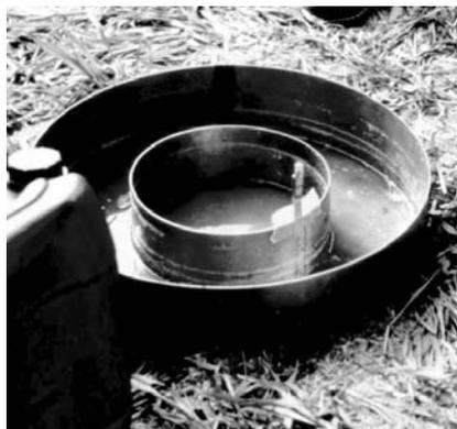
**Bild 1:** Durchlässigkeitsbestimmung nach DIN 19 682 mit Doppelringinfiltrometer.
