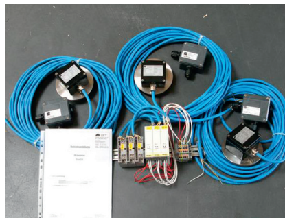
Bild: Neigungswinkelgeber zur Messung der Entlastungsaktivität, vor Auslieferung bei UFT
